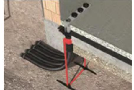
Dampfsperrfolien lassen sich an den aufgerauten Spachtelflansch anbinden. Die Höhe des Estrichaufsatzes lässt sich mithilfe der Höhenfixierung an den Fußbodenaufbau anpassen.
