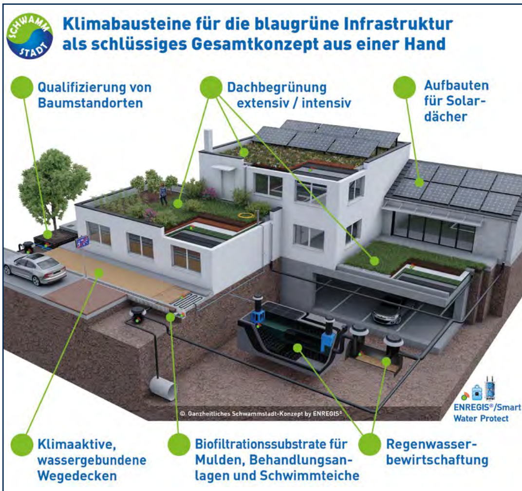
Schwamm statt Versiegelung – die Grafik zeigt den Lösungsansatz im Zusammenwirken aufeinander abgestimmter ENREGIS Produktbeispiele
